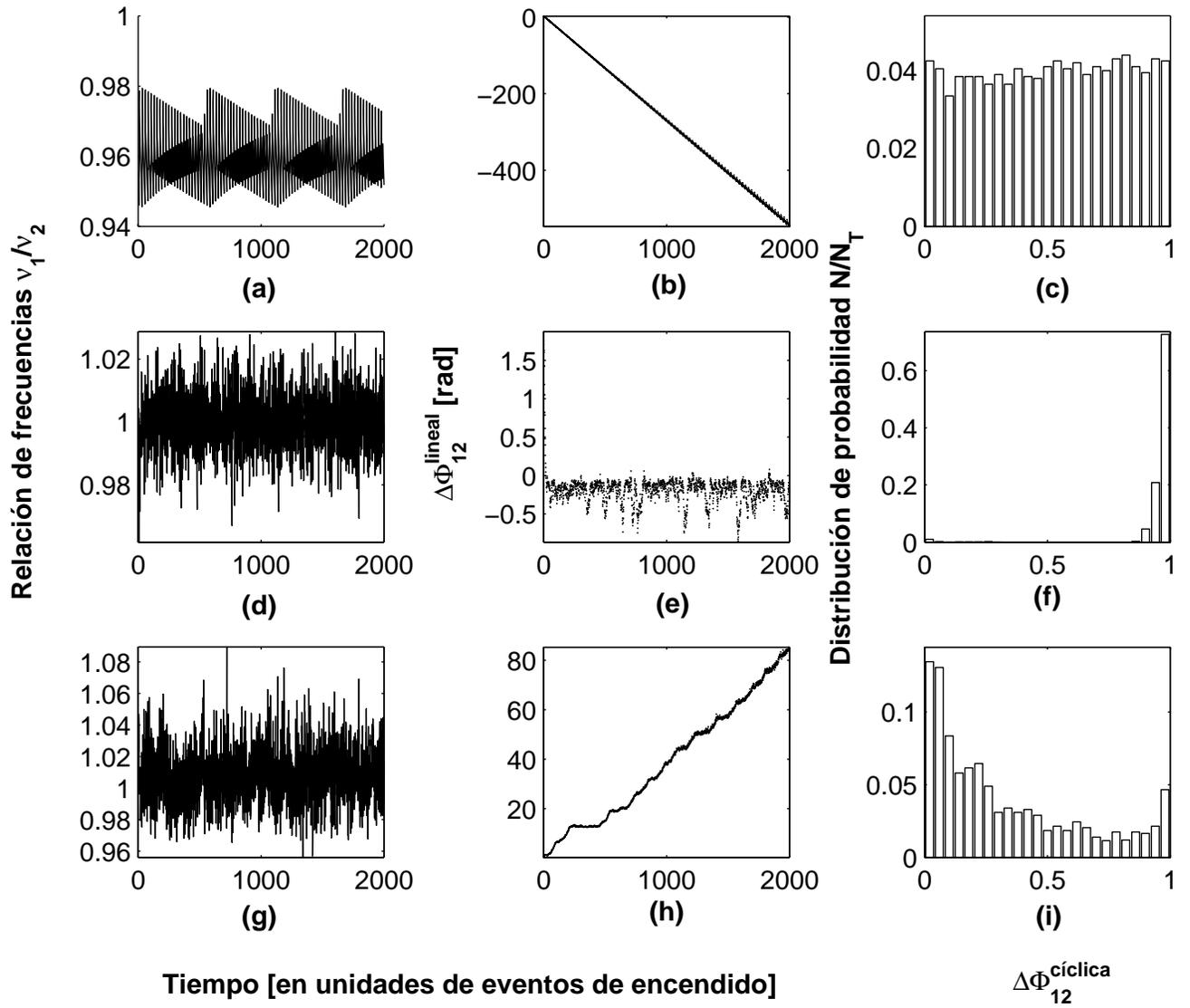
Figura 5. Relación de frecuencias  $\nu_1/\nu_2$ , evolución de la LPD, y distribución de probabilidades para la CPD en un sistema de dos LCOs acoplados con  $T_{01} = 34,0$  ms,  $T_{02} = 32,5$  ms,  $\beta = 100$ , y las varianzas de los ruidos Gaussianos que actúan sobre cada uno de los LCOs,  $\sigma_1 = 0,003$  y  $\sigma_2 = 0,001$ ; cuando las intensidades de ruido son (a)-(c) ( $\sqrt{D} = 0,00$ ), (d)-(f) ( $\sqrt{D} = 1,40$ ) y (g)-(i) ( $\sqrt{D} = 2,00$ ).
