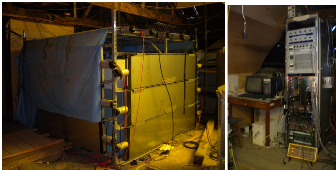
Figura 5: Monitor de Neutrones Solares; el conjunto de detectores y la electrónica de registro de datos
