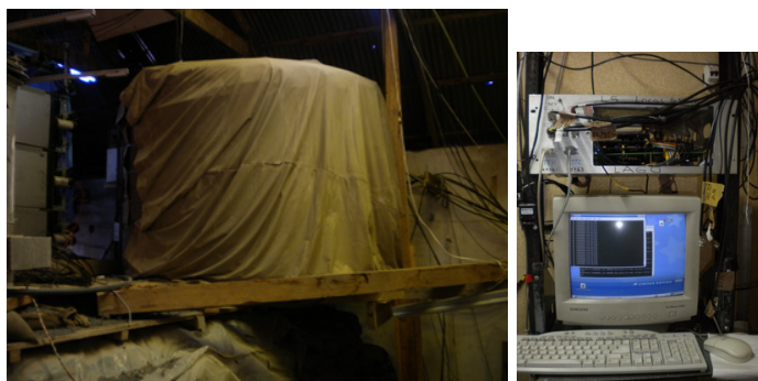
Figura 6: Experimento LAGO a 5240msnm: Detector Cherencov y su electrónica, basados en tanque de agua. Tres similares cubren un total de 10m^2 de superficie, equivalen a 10000mt^2 de superficie a nivel del mar
