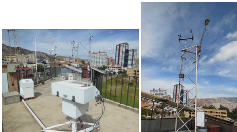
Figura 8: Instrumentos en Cota Cota, Espectrometro Brewer, Estación meteorológica
