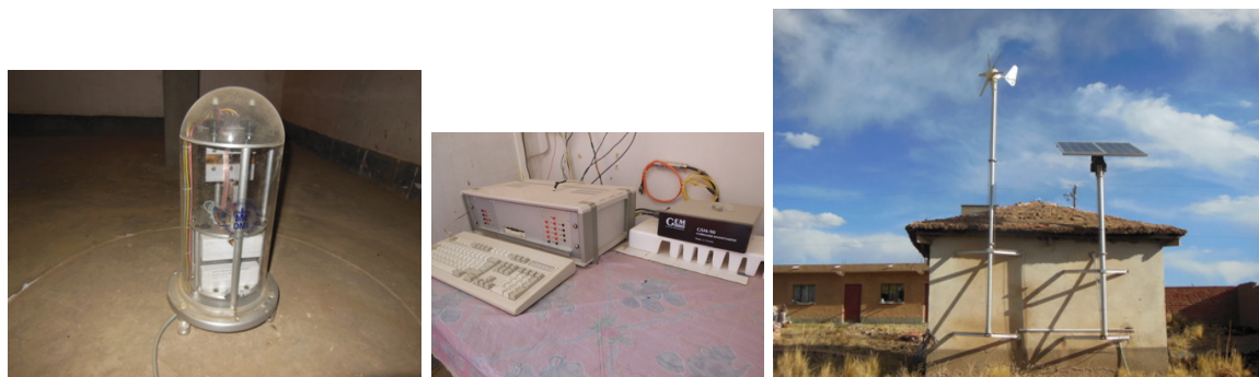
Figura 14: Instrumento instalado en Villa Remedios: Magnetómetro Fluxgate, Datalogger y Energía basada en eólico y celda solar
