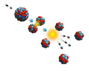
Se observa en la figura, el proceso por el cual un neutrón incide sobre un núcleo de Uranio y este al cabo de pocos nanosegundos se divide en dos núcleos, liberando tres neutrones y una cierta cantidad de energía. Los neutrones liberados a su vez chocan con otros
