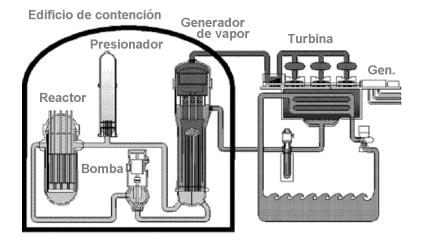
Se ilustra en la figura el esquema de un reactor nuclear a agua presurizada y los componentes de las que consta para generar energía eléctrica.
