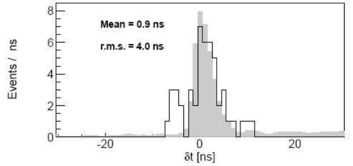
FIG. 3.— Distribución de los  $\delta t$ , la diferencia entre el tiempo de vuelo del neutrino y el tiempo de vuelo a la velocidad de la luz, para los 48 eventos seleccionados (histograma en negro), comparado con la superposición de los picos de las formas de onda correlacionados con los eventos detectados (histograma en gris).
