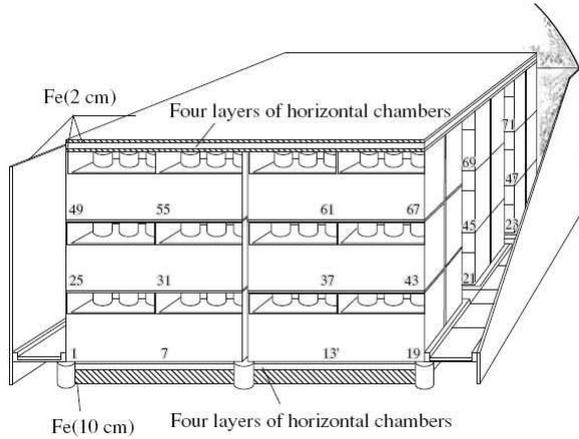
FIG. 1.— Las 90 toneladas del LSD en el laboratorio del Monte Blanco. En la figura no se muestran las 200 toneladas de la cubierta de Fe.
