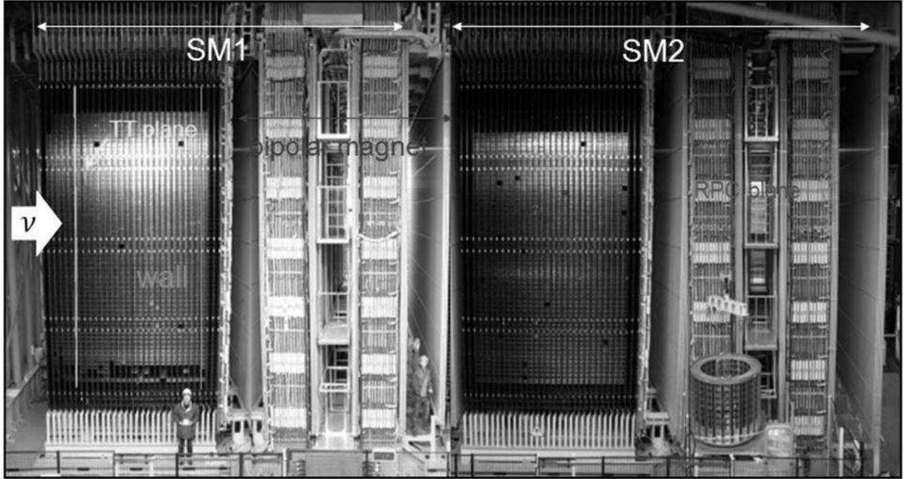
FIG. 1.— Detector de OPERA, la dirección de arriba del haz de neutrinos está indicada con una flecha. El detector tiene una estructura modular, donde cada super módulo es idéntico SM1 y SM2. Cada SM está formado por una zona de blanco constituida de 31 paredes de bricks (walls), instrumentados con planos de detectores de tipo trazante (TT plane). Detrás del blanco se halla un espectrómetro (bipolar magnet) equipado con planos de detectores de tipo resistivo (RPC plane).
