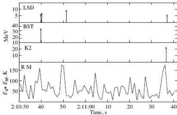
FIG. 9.— Datos gravados durante 57 s en diferentes experimentos bajo tierra y GWA, a partir de 2:10:40 UT en febrero de 1987. En este periodo 4 eventos LSD (LSD tiene una tasa de disparo de 0.7 eventos por minuto) están en coincidencia con los eventos en otros experimentos. La curva inferior es el gráfico temporal de la suma de los pulsos cada 0.1 s para GWA de Maryland y Roma.
