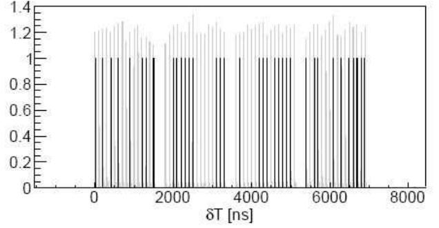
FIG. 2.— Comparación de los valores de  $\delta T$  de los 48 eventos seleccionados (líneas negras) con las formas de ondas sumadas de la extracción de protones (líneas grises). El origen del tiempo de las formas de ondas están dados por el máximo del primer grupo.
