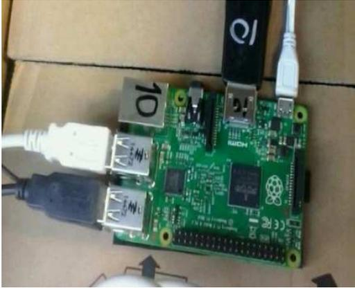
FIG. 4.— Fotografía de la minicomputadora Raspberry PI2.
