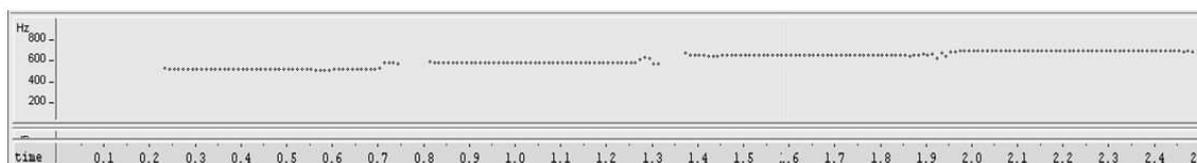
FIG. 4.— Plano melódico (frecuencia  $f_1$  función del tiempo) de las 4 notas do, re, mi, fa realizadas con flauta dulce.
