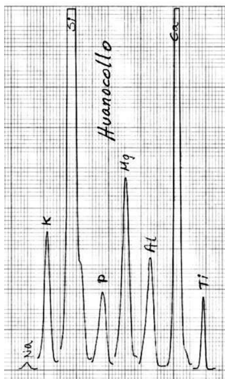
Figura 3. Registro de elementos ligeros, incluyendo Ti y Ca, obtenidos manualmente con dispersión por diferentes cristales.
