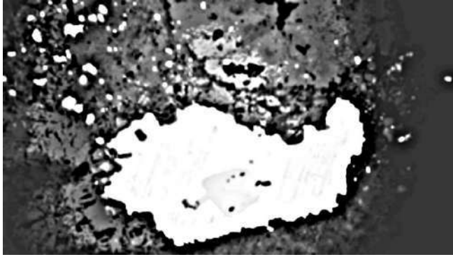
Figura 6. Inclusión de troilita en taenita, indicando un solo origen de ambas fases. Ambas incluidas en la roca. Aumento: 200 X.
