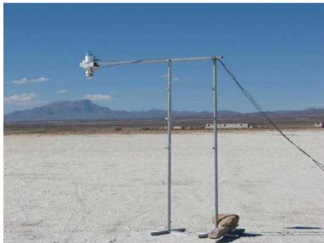
FIG. 1.— Arreglo experimental utilizado para medir el albedo. El sistema permite la variación de altura entre los domos y el suelo y, además, permite calibrar la horizontalidad.
