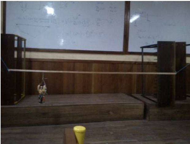
FIG. 8.— Un muñeco en la posición calculada, logrando poner horizontal al palo.
