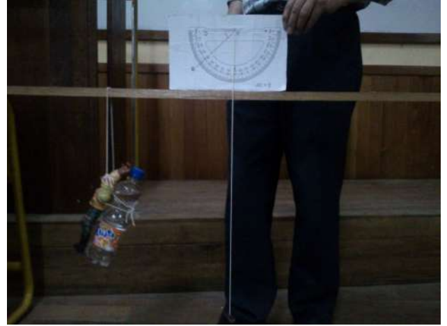
FIG. 9.— Manera de usar el transportador para medir el ángulo.
