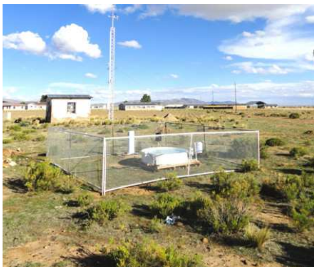
FIG. 1.— (Color online) La estación meteorológica de Patacamaya, en primer plano los sensores de evaporación y precipitación. Al fondo la torre con los sensores principales, la caja de control y la caseta de monitoreo.
