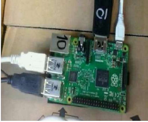
FIG. 4.— Fotografía de la minicomputadora Raspberry PI2.
