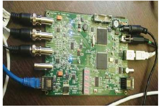
FIG. 2.— Fotografía del conversor TDC que sirvió para digitalizar los pulsos eléctricos.
