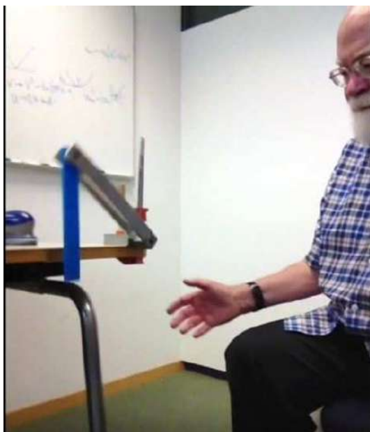
FIG. 2.— Péndulo doble en funcionamiento y que presenta una gran variedad de comportamientos, desde regulares hasta caóticos. El vídeo mostrando el movimiento de este péndulo en diferentes situaciones, se lo puede ver en YouTube (2016). Foto tomada en Dresde el sábado 8 de octubre de 2016 en el MPIPES.
