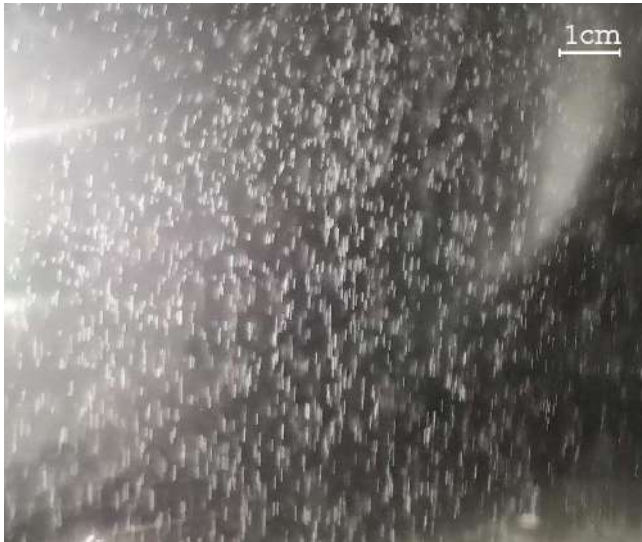
FIG. 2.— Vista del interior de la cámara de niebla cuando el vapor de alcohol ha llegado al estado de sobresaturación.
