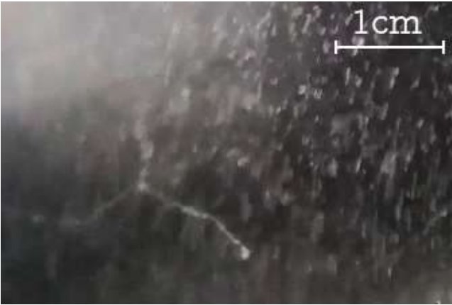
FIG. 8.— Se observa el paso de una partícula que repentinamente produce dos trazas en diferentes direcciones, lo cual puede corresponder a una “creación de pares”.
