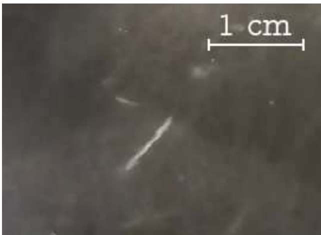
FIG. 3.— Traza corta y gruesa dejada por una partícula \alpha , ya que interactúa con facilidad en el medio.
