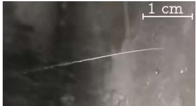
FIG. 4.— Se observa una trayectoria recta y delgada, este tipo de estela es producida por electrones e^- o positrones e^+ muy energéticos.
