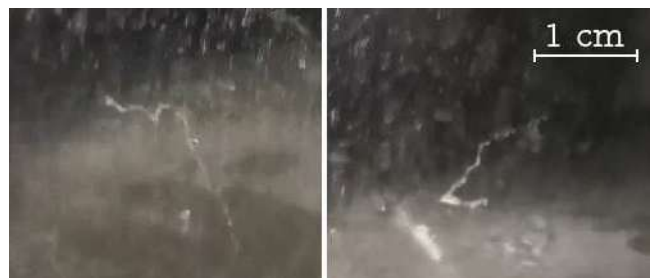
FIG. 6.— Tipos de trazas producidas por electrones o positrones de baja energía cinética.
