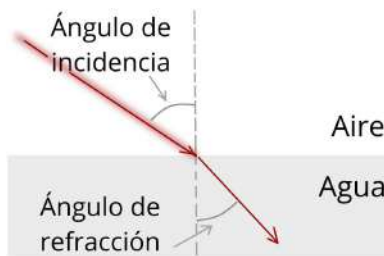
FIG. 6.— Refracción de la luz.
