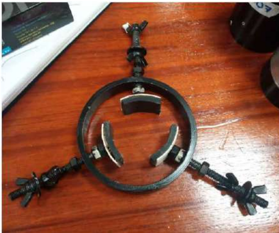
FIG. 6.— Argolla metálica diseñada para mantener el PMT fijo al tubo de PVC.
