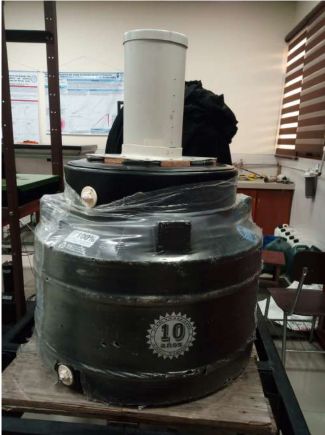
FIG. 5.— Modificaciones realizadas a la tapa del tanque más el acople del tubo PVC.
