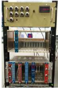
FIG. 10.— Distribuidor de alto voltaje y fuente de alto voltaje en la canastilla NIM.
